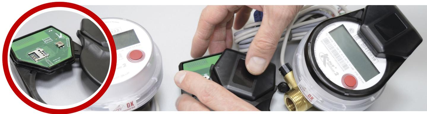
Коммуникационный модуль КАРАТ-923 предназначен для дооснащения теплосчетчика КАРАТ-Компакт 2-223 с целью расширения его коммуникационных функций
